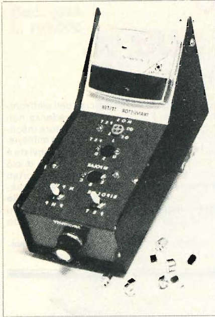
Fig. 2 - Aspetto dello strumento dettagliato nella figura 1. Sul pianale del contenitore si notano gli zoccoli per i transistori da misurare e gli interruttori S1, S3. S2 è monocomandato con il potenziometro della sensibilità; la relativa manopola sporge in primo piano.
