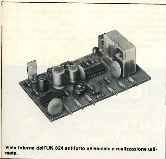
Fig. 3 - Il condensatore da 470 µF va installato per ovviare ai disturbi generati da altre fonti.
